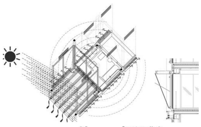
de los patios orientados a la fachada Norte, siempre en sombra y enfriados mediante la evapo-transpiración debida a la vegetación allí plantada. Si es necesario, este aire pasa, después, a la máquina adiabática, con lo que se completa la refrigeración hasta alcanzar una temperatura de confort propuesta en 25 °C.
