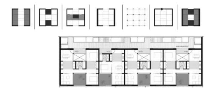
2.- La estructura matricial propuesta permite descomponer la complejidad del programa en diferentes niveles para responder específicamente a cada uno de ellos de la mejor manera posible. El tipo edificatorio, de este modo, es el resultado final de combinar los diferentes módulos o células.
